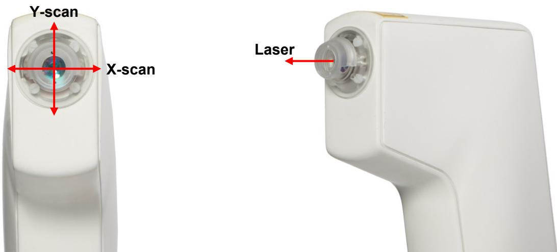
Der Sensorkopf wurde für einen komfortablen Gebrauch in der linken oder rechten Hand entwickelt. Er ist in jeder Richtung anwendbar für einen leichten Zugang zu der Körperstelle, die gescannt wird. Er beinhaltet eine Farbkamera (mit LED-Beleuchtung), die auf dem Bildschirm den Hautbereich zeigt, der untersucht wird, sowie die exakte Stelle der Scanlinie, um dem Benutzer dabei zu helfen, den Scan im jeweiligen Bereich zu positionieren.
